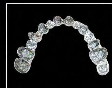
図11 レーザーシントリング法にて作製したフレーム
